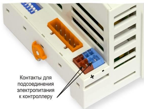
Рис. 3.7 Присоединение электропитания контроллера
