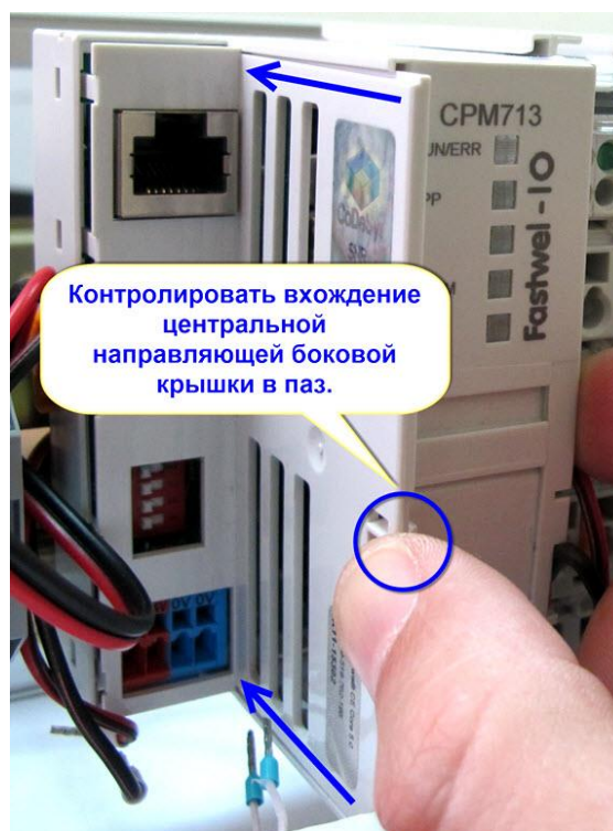
Рис. 5.10 Установка боковой крышки
